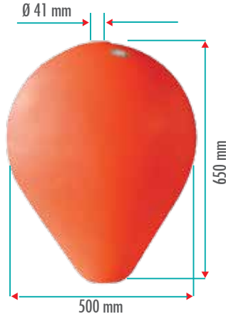
M03552 70 LT ŞAMANDIRA / BUOY Yüzdürmesi / Buoyancy: 60 kg Ürün Ağırlığı / Weight: 8,5 kg Ortasında monoblok polietilen boru mevcuttur. İç boşluğu tamamen poliüretan ile kaplıdır. Dış yüzeyi polietilen malzemedir. Usage: Marking applications. Raw material: Polyethylene Inside: Polyurethane filled.
