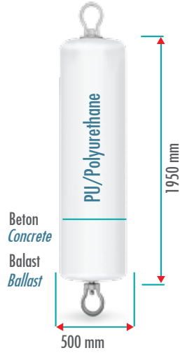
M03251 390 LT ŞAMANDIRA / BUOY Ürün Ağırlığı / Weight: 114 kg
